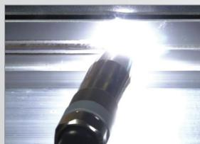
Assemblage par soudure robotisée procédé C.M.T. (cold metal transfer)
